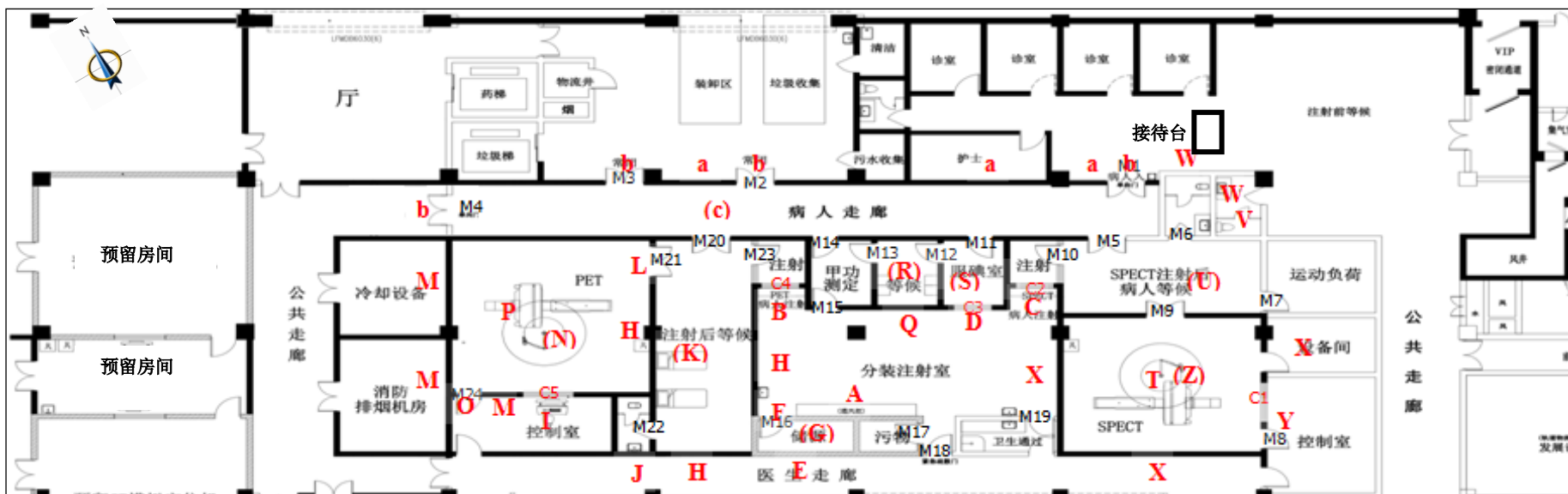
图 11-1 北侧核素显像诊断区域工作场所预测关注点位示意图
